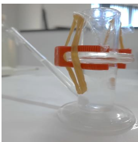
Figure 17 : Le montage de la cellule avec membrane et crème
