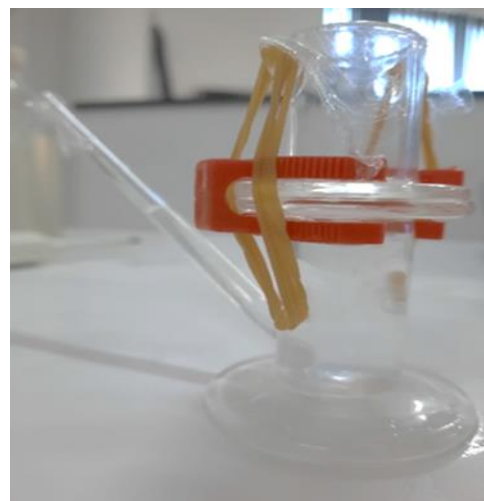
Figure 16 : Image réelle de la cellule de Franz utilisée
