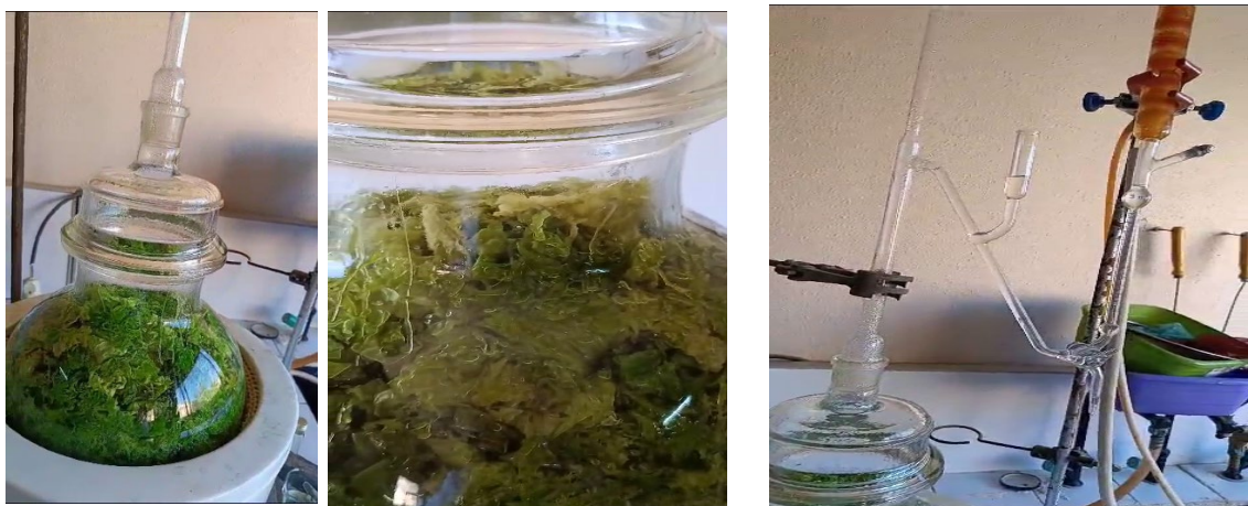
Figure 20:ballon de distillation, matière végétale (ph.orig.2024)
