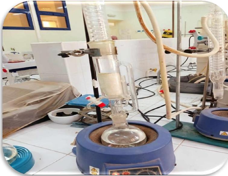
**Figure 24** : Montage de l'extraction de lanoline à partir de la laine brute par soxhlet. **(Photo original)**
