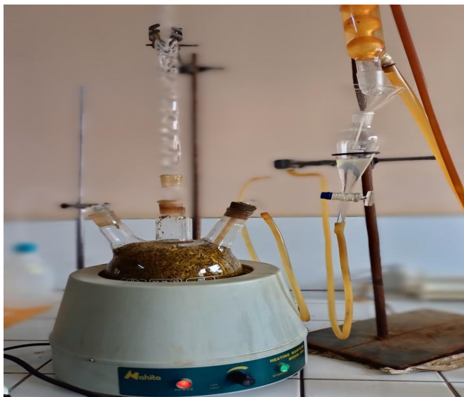
Photo N° 3 : Montage de l'appareil d'hydrodistillation lors de l'extraction de l'huile essentielle de thym.
