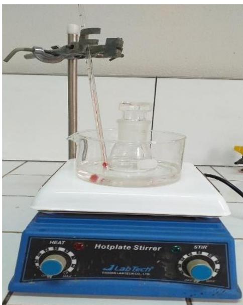
**Figure 22:** Agitation du mélange avec chauffage à différentes températures.
