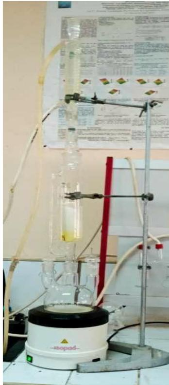
**Figure 18:** Dégraissage de biosorbant par la technique de soxhlet.
