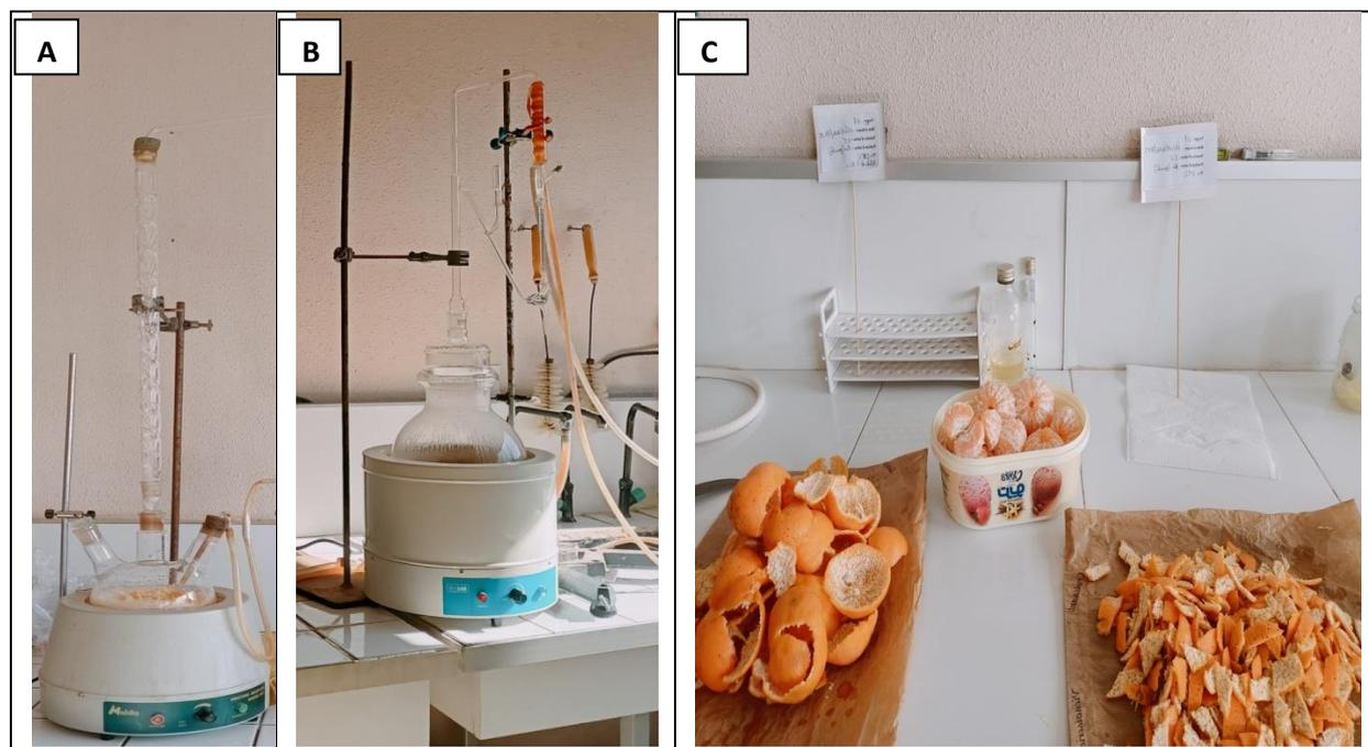
A : Hydrodistillation classique, B : Hydrodistillation avec un appareil de type Clevenger, C : Ecorces de *Citrus reticulata*
