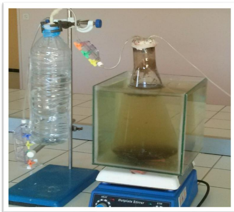
Figure 21 : photo du digesteur.
