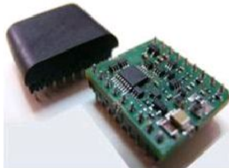
Figure_ III.1. Mini-modem CPL « WPC IP »
