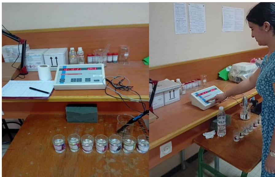
Fig. 3.22 : Mesure de la conductivité électrique.
