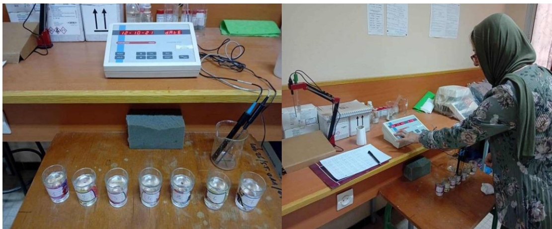
Fig. 3.20 : Mesure de la conductivité électrique.
