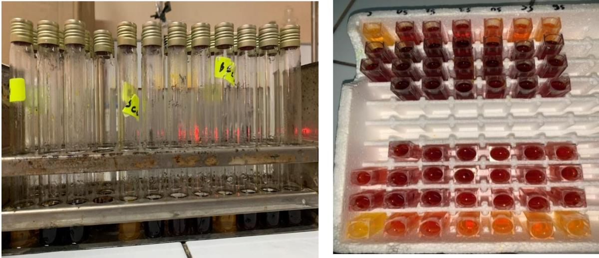
**Figure 11.** Coloration des réactions enzymatiques après l'ajout du DNSA (photos prises au labo)
