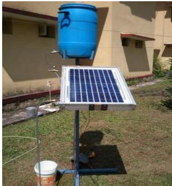
Figure I.11. Système hybride d'eau PV/T [15].
