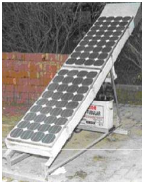
Figure I.5. Banc d'essai du capteur solaire hybride PV/T à air[7].
