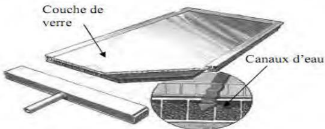
Figure I.9. Schéma du capteur solaire PV/T hybride à eau SolarNor [13].
