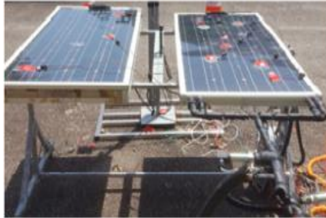
Figure I.13. Vue du panneau PV et du capteur 'PV/T à eau[18].
