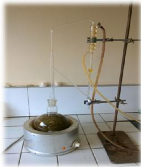
Figure 10: Extraction des HEs par hydrodistillation
