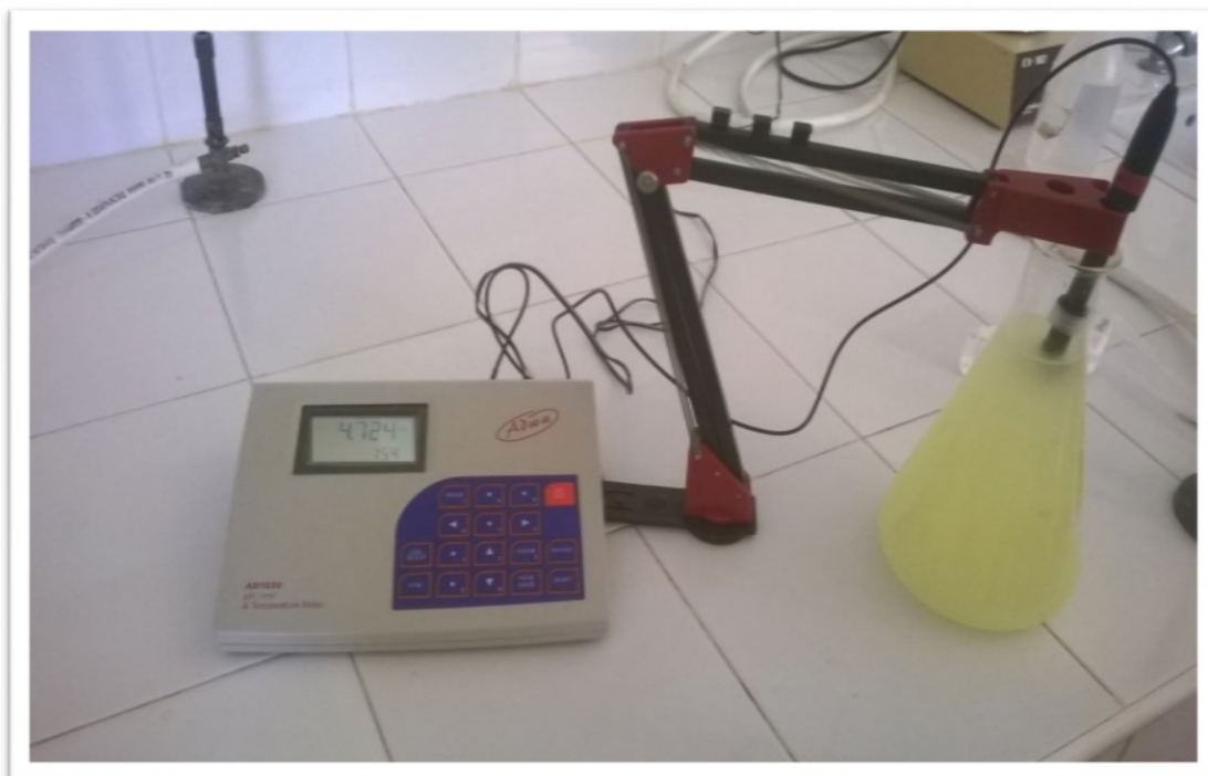
Figure.6 : pH mètre pour la mesure de pH et température de lactosérum ( photo original ).
