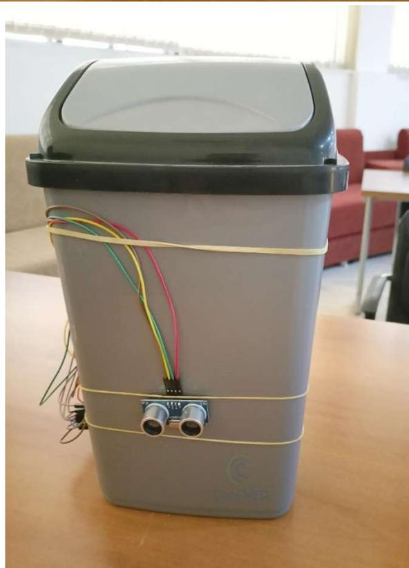
Figure 24 : Prototype physique de la poubelle « Cont-MED »
