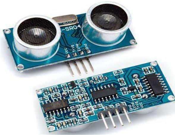
Figure 12 : capteur « HC-SR04 »
