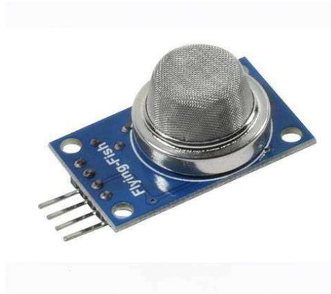
Figure 13 : capteur « MQ135 »
