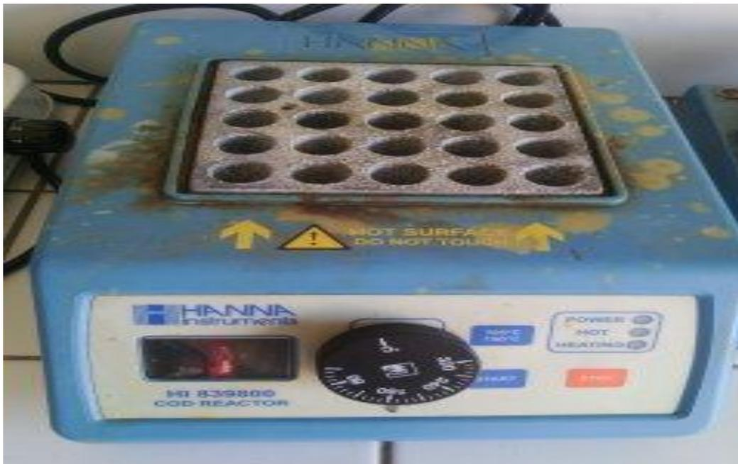
Figure n° 5 : Thermo réacteur (photo originale)
