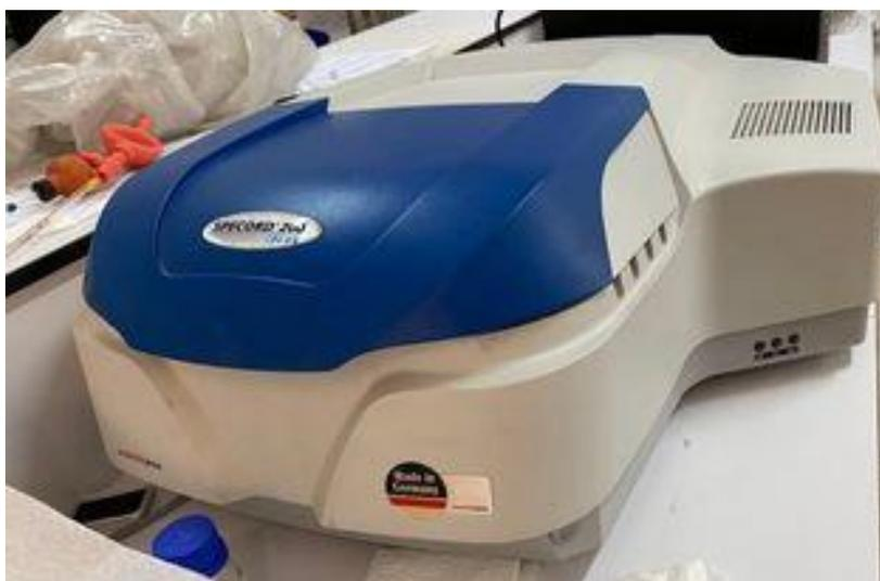
**Figure II.8 : Spectrophotomètre UV visible.**
