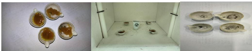
**Figure 19** - Creusets d'incinération de nos échantillons (Photo prise par El Ouchdi et Ghaffour).
