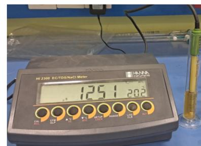
Figure 17 - Conductimètre (Photo prise par El Ouchdi et Ghaffour).
