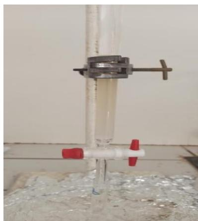
**Figure III- 14:** La colonne de silice
