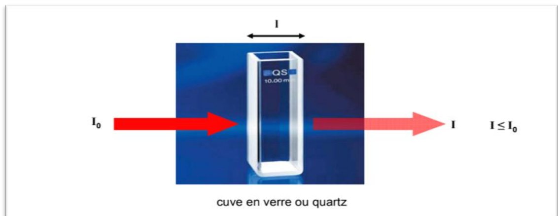
Figure 2.5 : Le principe de lecture d'un échantillon en spectroscopie UV-Visible.
