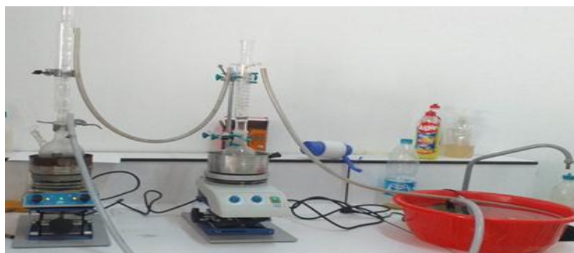
Figure 2.1 : Schéma du montage pour la synthèse des nanoparticules d'or utilisant le citrate de sodium et l'acide tannique.
