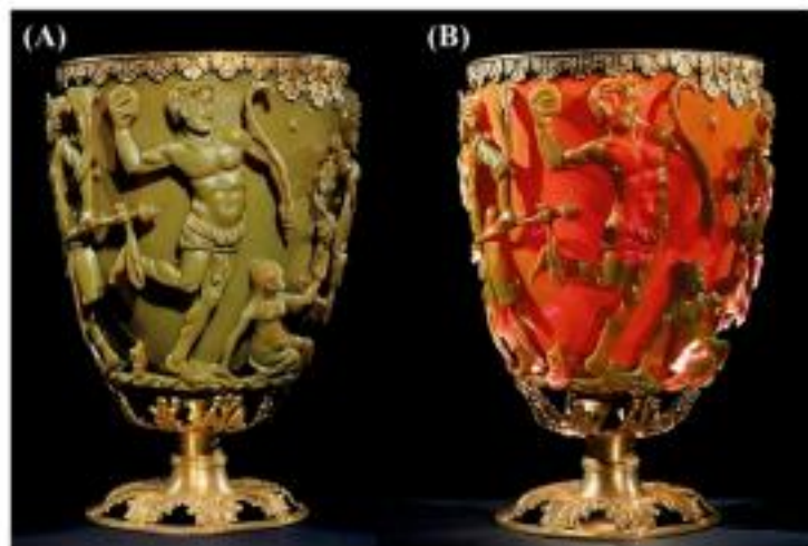
Figure 1.1 : La coupe de Lycurgue. Le verre apparaît vert en lumière réfléchie (A) et rouge-violet en lumière transmise (B) (3).
