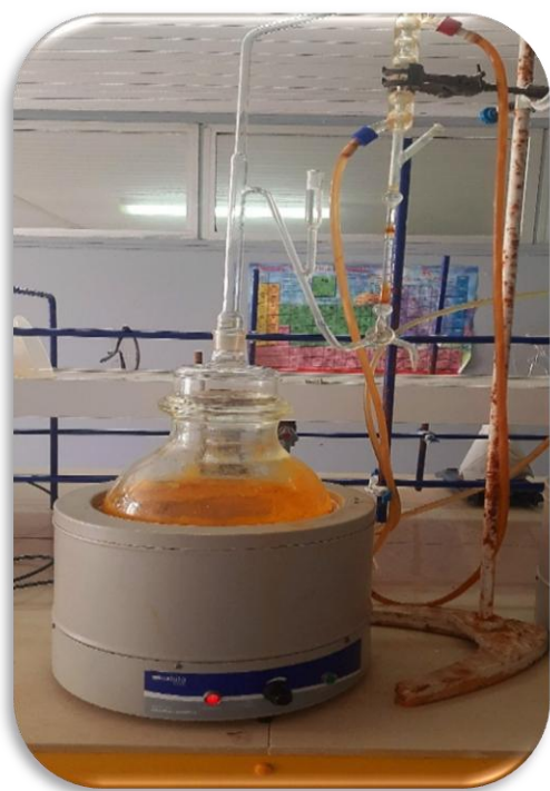
Figure IV.7: Dispositif d'extraction de l'HE du Curcuma longa L. par la méthode d'hydrodistillation de type Clevenger
