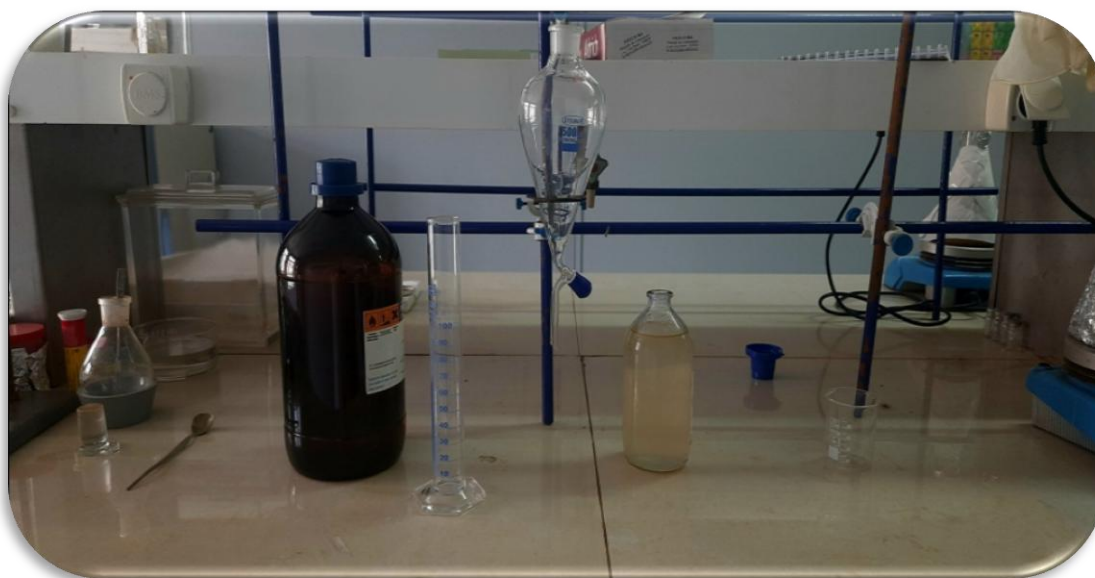
Figure IV.10: L'extraction liquide-liquide de l'hydrolat
