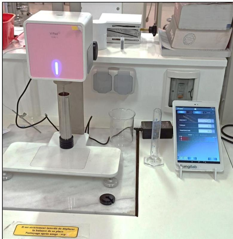
**Figure II.10** : Mesure de la viscosité des cultures à base du CMC avant et après hydrolyse enzymatique avec le viscosimètre automatique (FUNGILAB) (**Original, 2023**)
