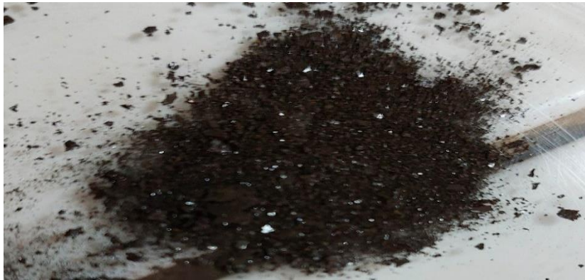
Figure 11 : Nanoparticules d'argent en poudre.
