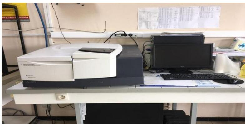
**Figure II.2 :** Appareil de spectroscopie infrarouge à transformée de Fourier.
