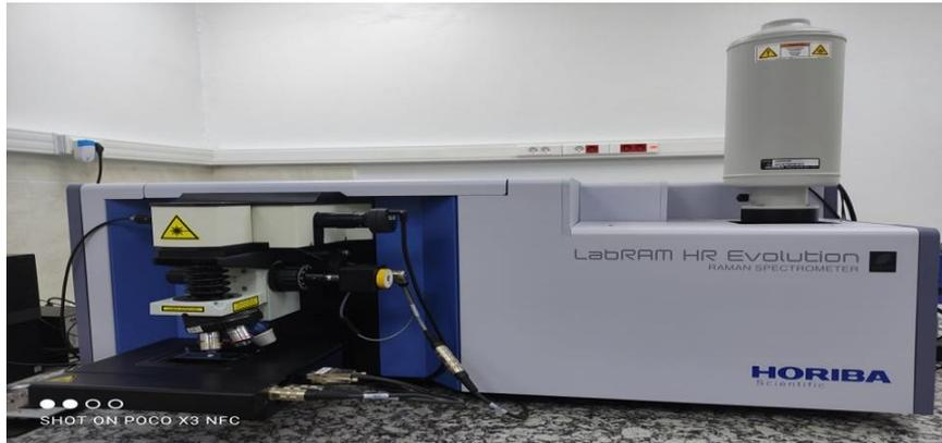
**Figure II.4 :** Appareil de spectroscopie Raman
