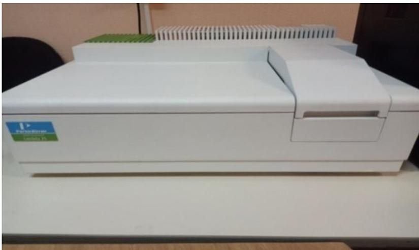
**Figure II.7** : PerkinElmer UV visible spectrometer lambda 25
