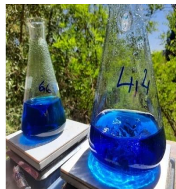
Figure III.12. Procédé héli-photo-Fenton sur le CV et le BM
