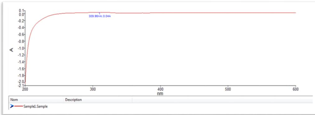
**Figure V. 10:** Le spectre d'absorbance de CAP dans le méthanol à  $\lambda_{max}=309,95$  nm.
