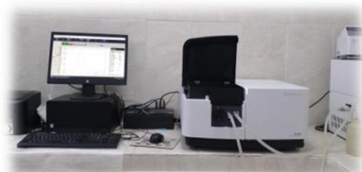
**Figure 2:** Spectrométrie par fluorescence X.
