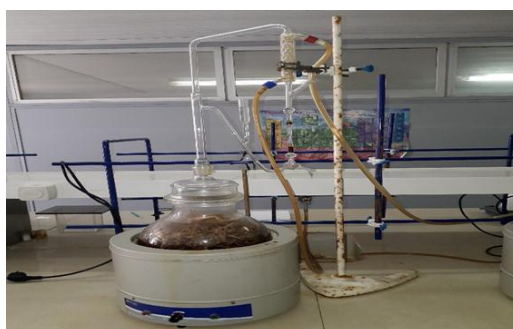
Figure 5: montage expérimental de l'hydrodistillation
