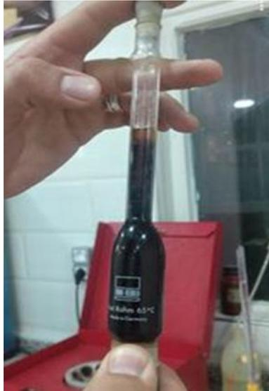
**Figure III.9:** Butyromètre et centrifugeuse
