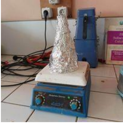
Fig. 2.8 : Extraction par macération dans le méthanol
