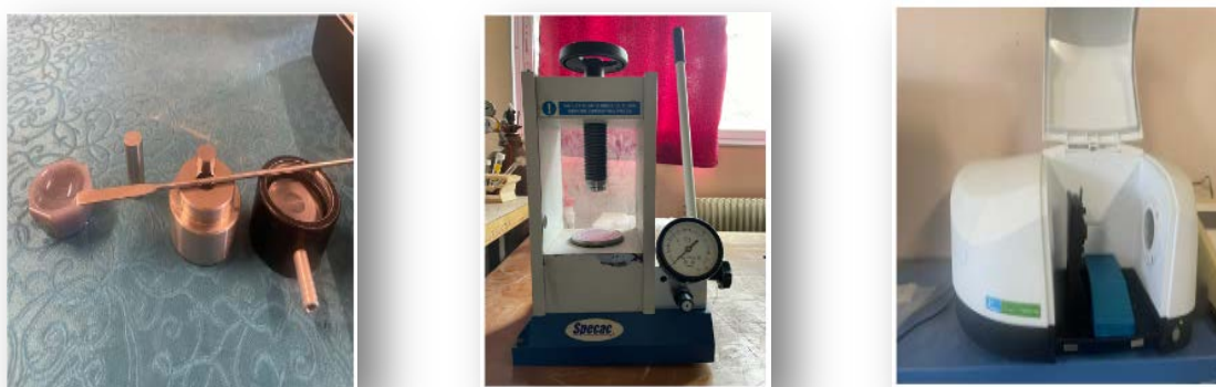
Figure II.6 : Matériel et appareil utilisés pour l'analyse par spectroscopie FT-IR .
