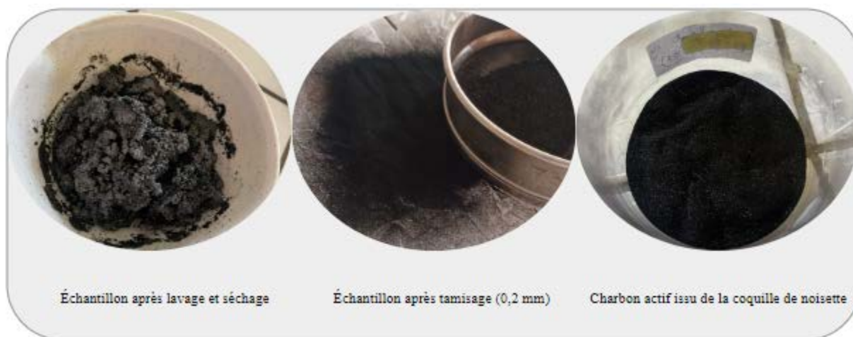
Figure II.4 : Préparation du charbon actif de la coquille de noix.
