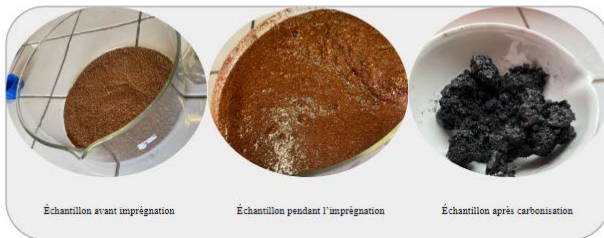
Figure II.3 : Activation chimique et thermique (carbonisation) de la coquille de noix.
