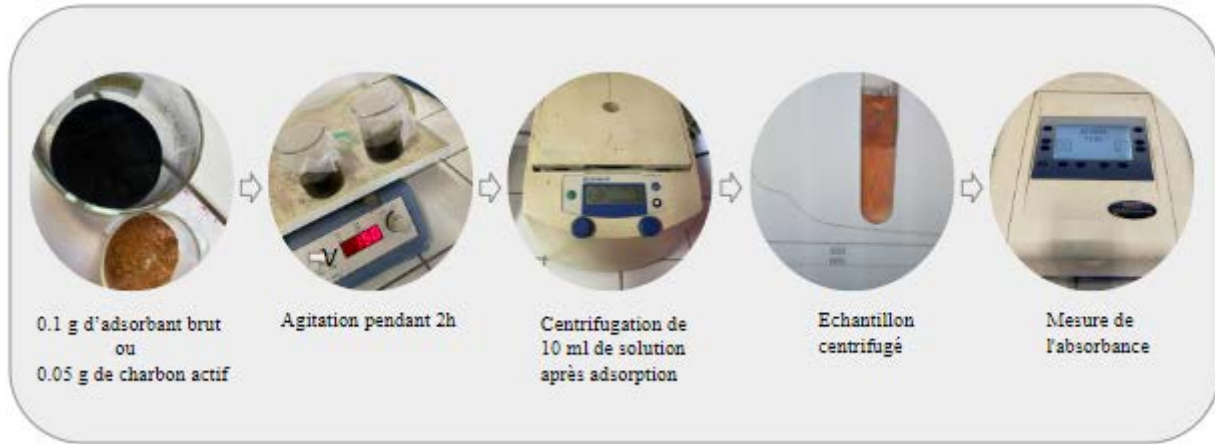
Figure II.9 : Schéma des étapes de l'étude d'adsorption du \text{KMnO}_4 .
