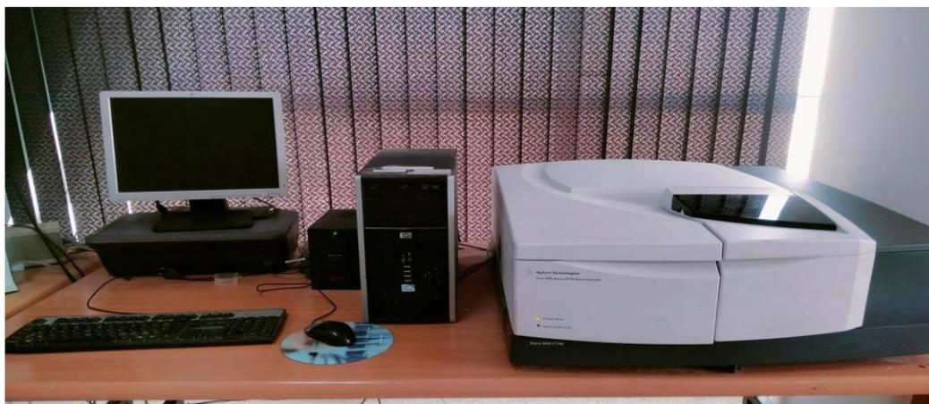
*Figure II.7 : Spectromètre infrarouge Agilent Technologies-Cary 640 (FTIR).*
