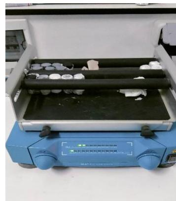
*Figure II.5.c : Agitateur mécanique*
