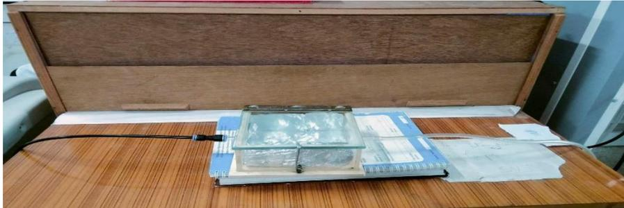
*Figure II.2 : Dispositif de photo polymérisation UV.*
