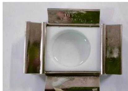
*Figure II.3.b : Porte échantillon en téflon*
