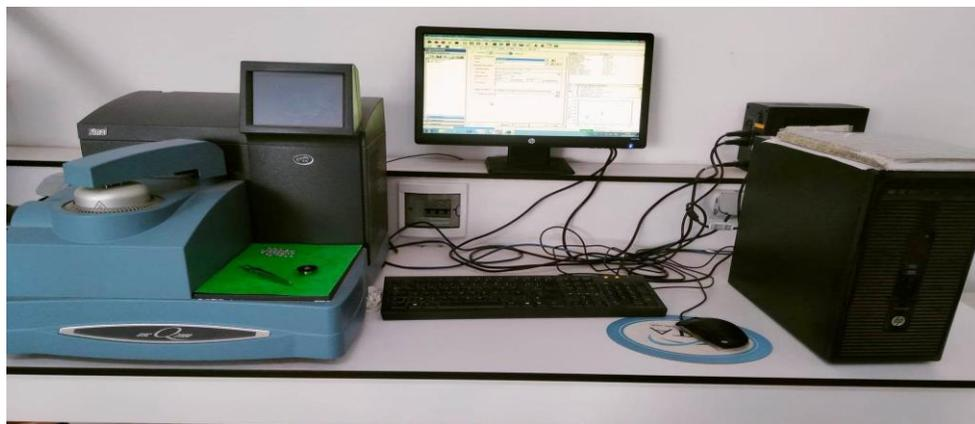
Figure III.13 : Dispositif expérimental de la DSC TA Instruments Q2000.
