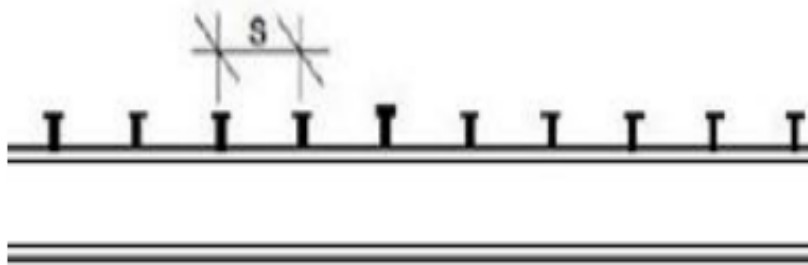
Figure IV. 9: Espacement entre connecteurs. [13]
