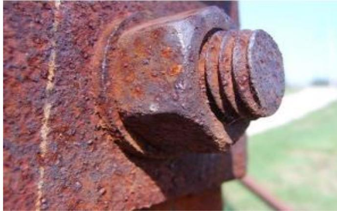
Figure 1. 3: Corrosion généralisée affectant la surface d'une pièce métallique [9]
