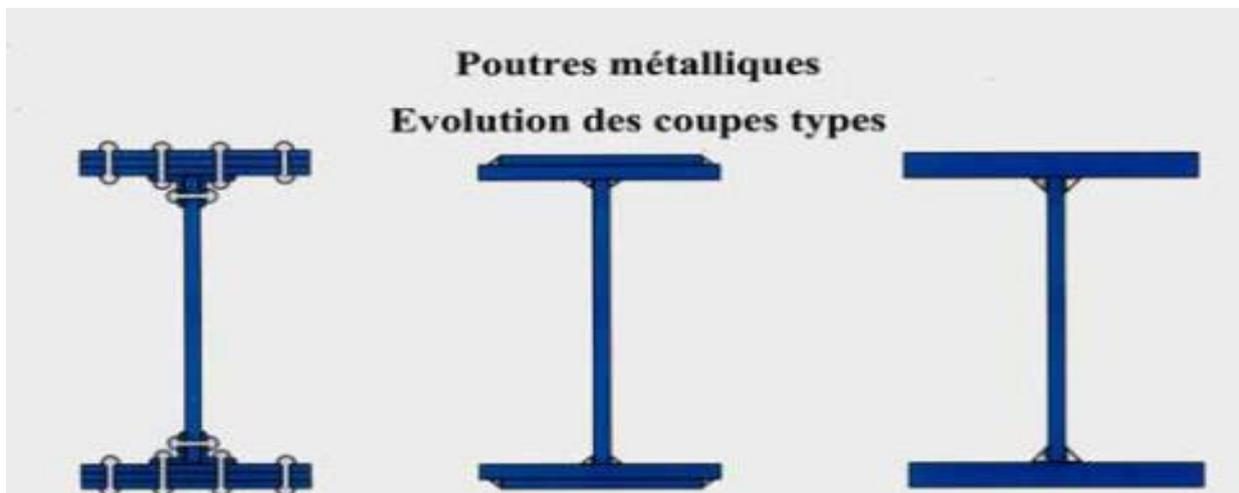
Figure 2. 5: Poutres métalliques – Evolution des coupes types [21].
