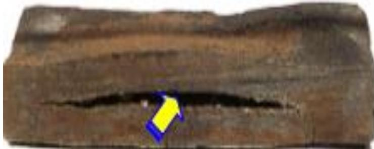
Figure 1. 8: La fragilisation par hydrogène d'une pièce métallique. [9]
