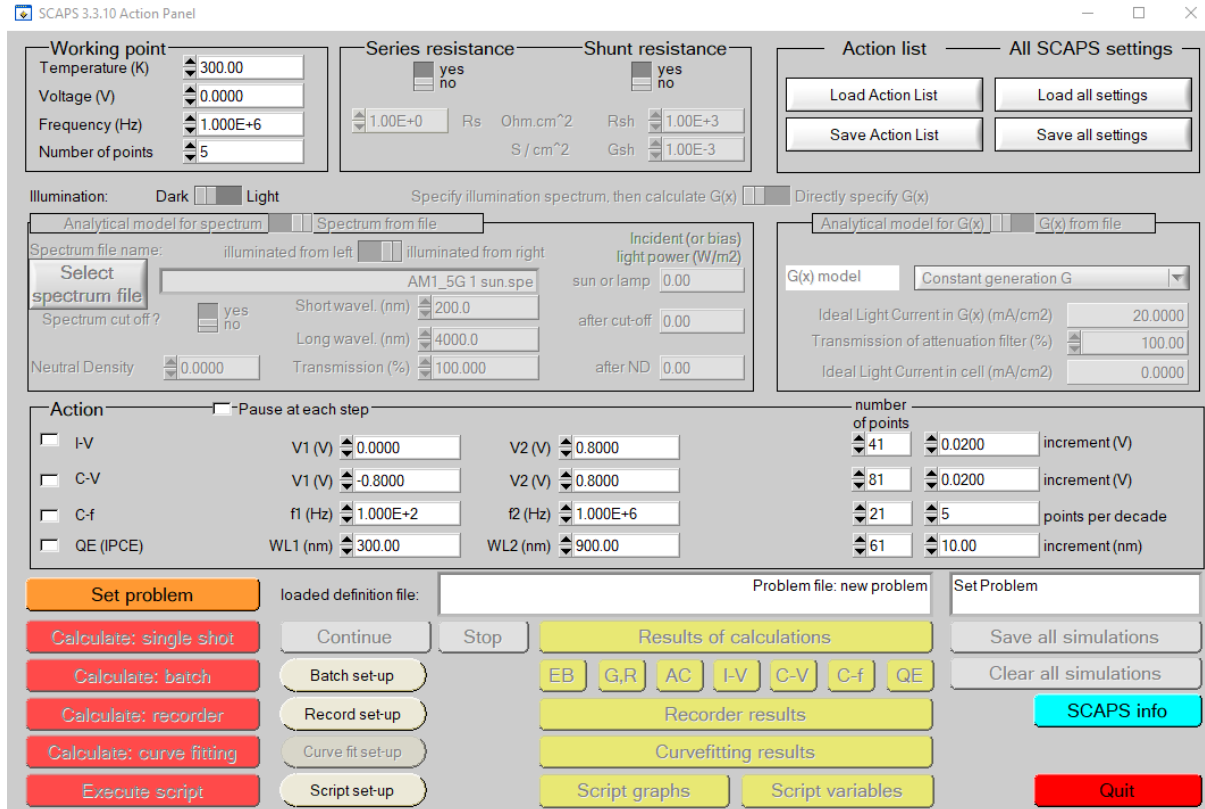
Figure III- 2. Fenêtre d'exécution « action panel » du logiciel SCAPS
