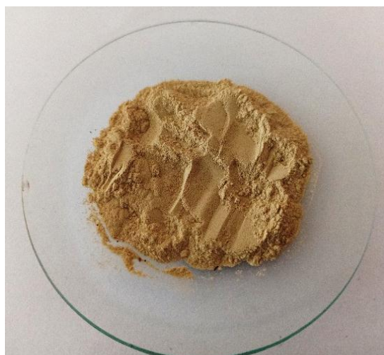
Figure II.1 : Bentonite sodique Na-Bt.
