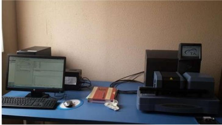
Figure II.7 : Appareil TA-Q600 couplé DSC/ATG
