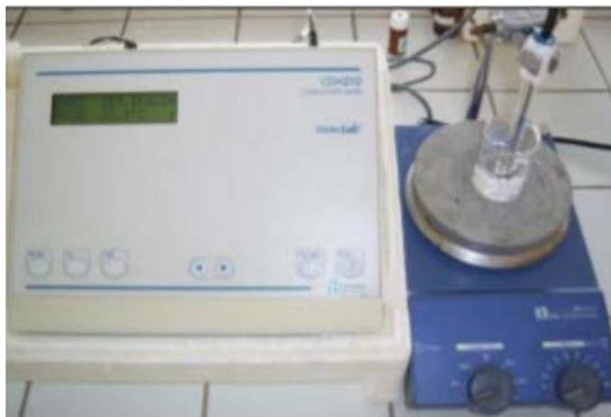
*Figure II.2 : Conductimètre de type CDM 210*
