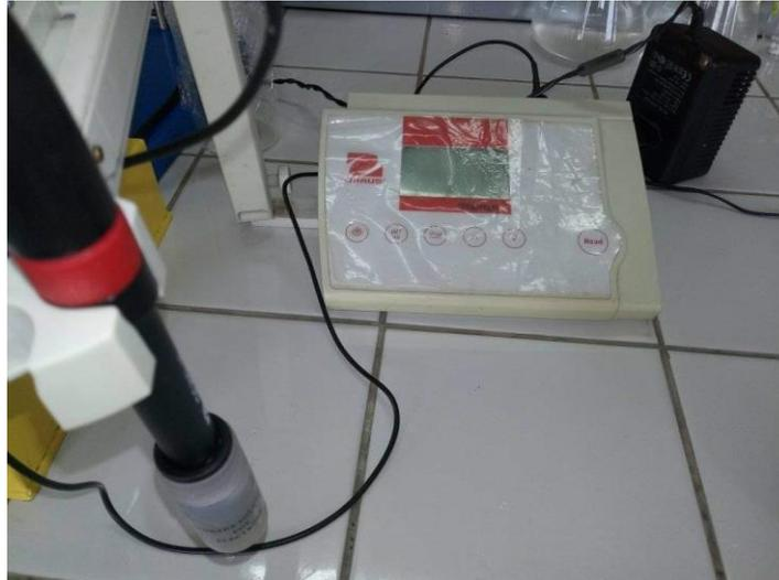
*Figure II.3 : Appareil pH-mètre type OHUAS*
