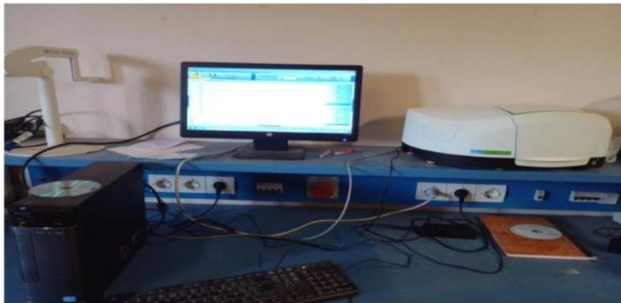
*Figure II.6 : Spectromètre FTIR CARY 600 SERIES*
