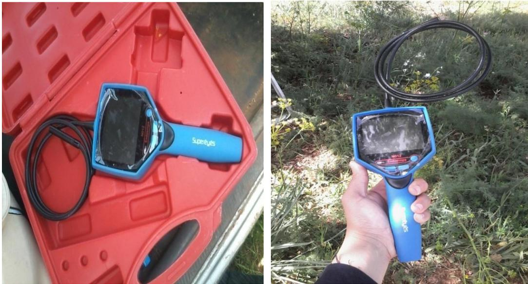
**Figure 16** - Endoscope pour la prospection des nids à distance (Super Eyes) (Originale)
