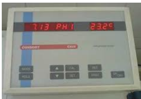
Figure n°12 : Appareil multi-paramètre de laboratoire pH, T° et conductivité (Consort C832)
