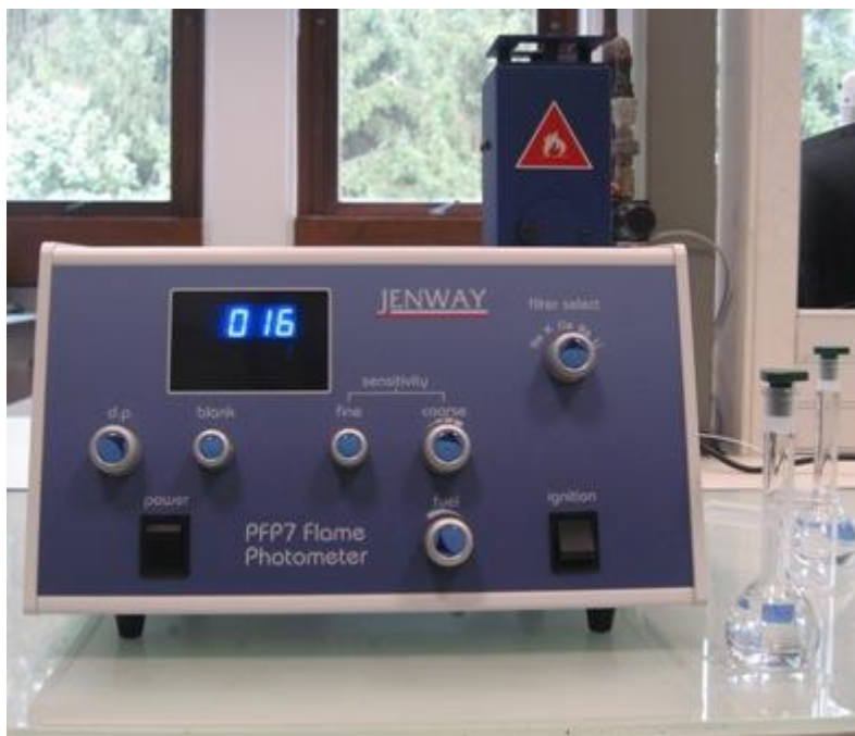
Figure n°14 : Spectrométrie d'émission de flamme (ou photométrie de flamme)
