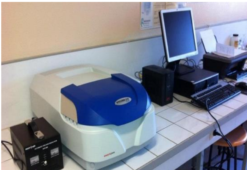
Figure A2 : Un spectrophotomètre UV visible SPECORD® PLUS
