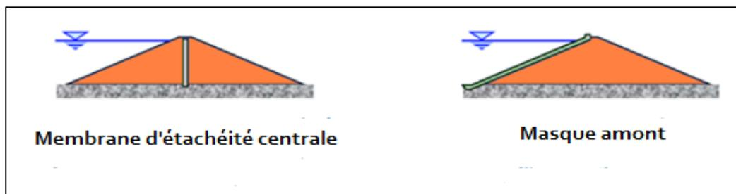
**Figure I.5:** Barrage en enrochement à masque amont ou central [6]
