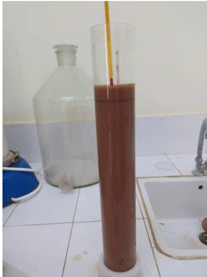
Photo 11 : Echantillon près pour l'analyse granulométrique, (Photo de l'auteur).
