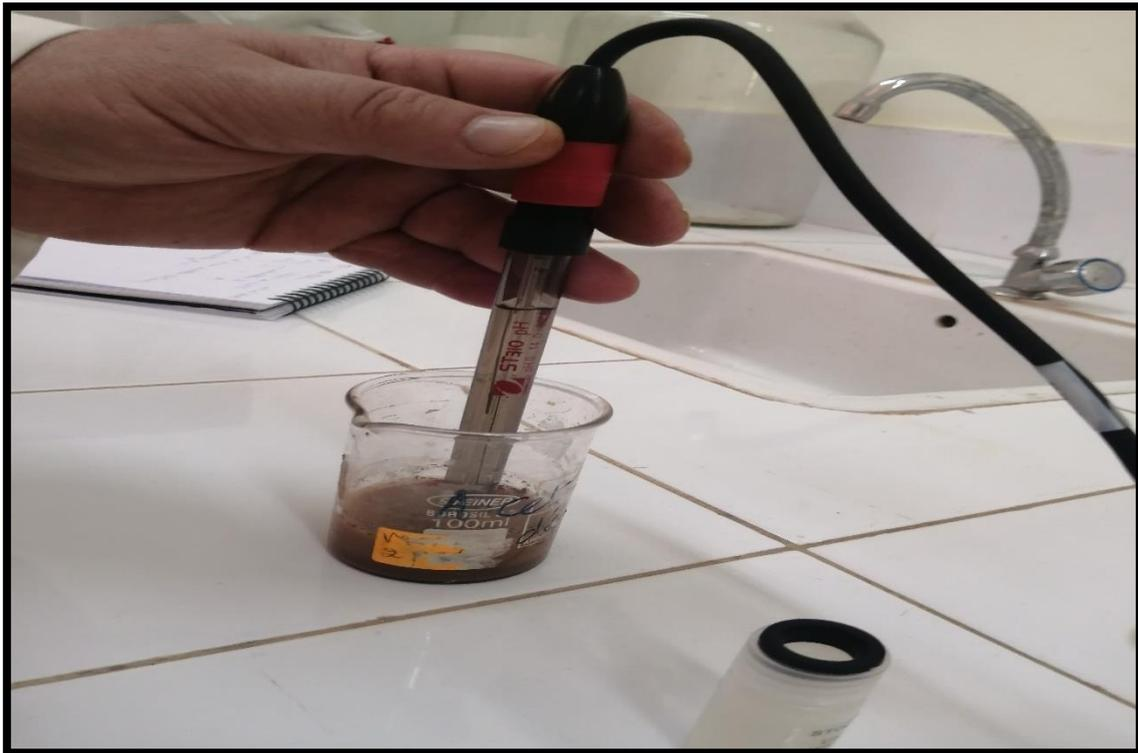
Photo 9 : L'électrode dans la suspension pour effectuer la lecture du Ph H<sub>2</sub>O (original)
