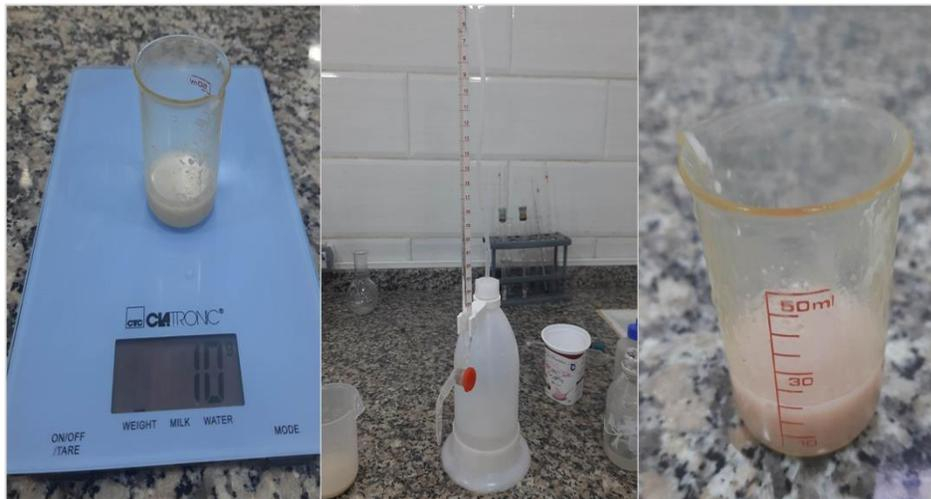
**Figure 3.7** : Détermination de l'acidité titrable du lait.
