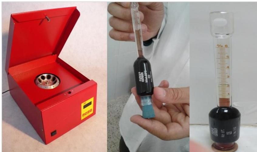
**Figure 3.8** : Détermination de la MG du lait par méthode de Gerber.
