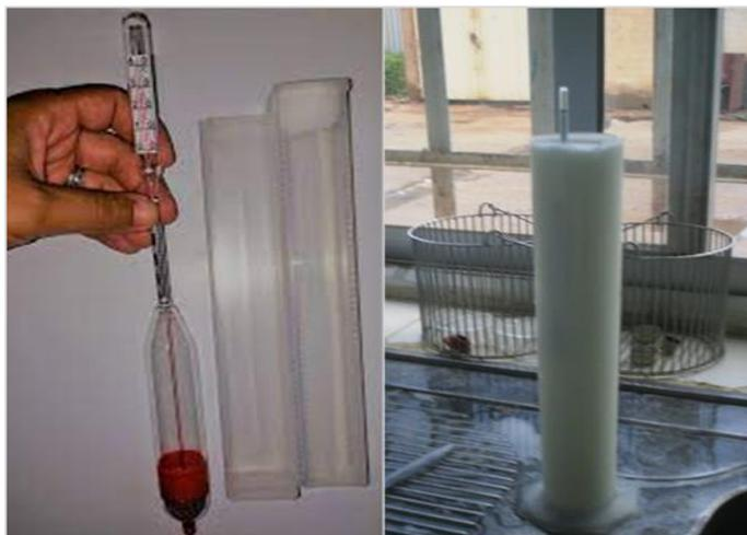
**Figure 3.6 :** Détermination de la densité du lait par thermo- lacto-densimètre.
