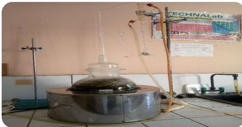
Figure 12- Montage d'un hydro distillateur type Clevenger (Lahouaou ,2023)
