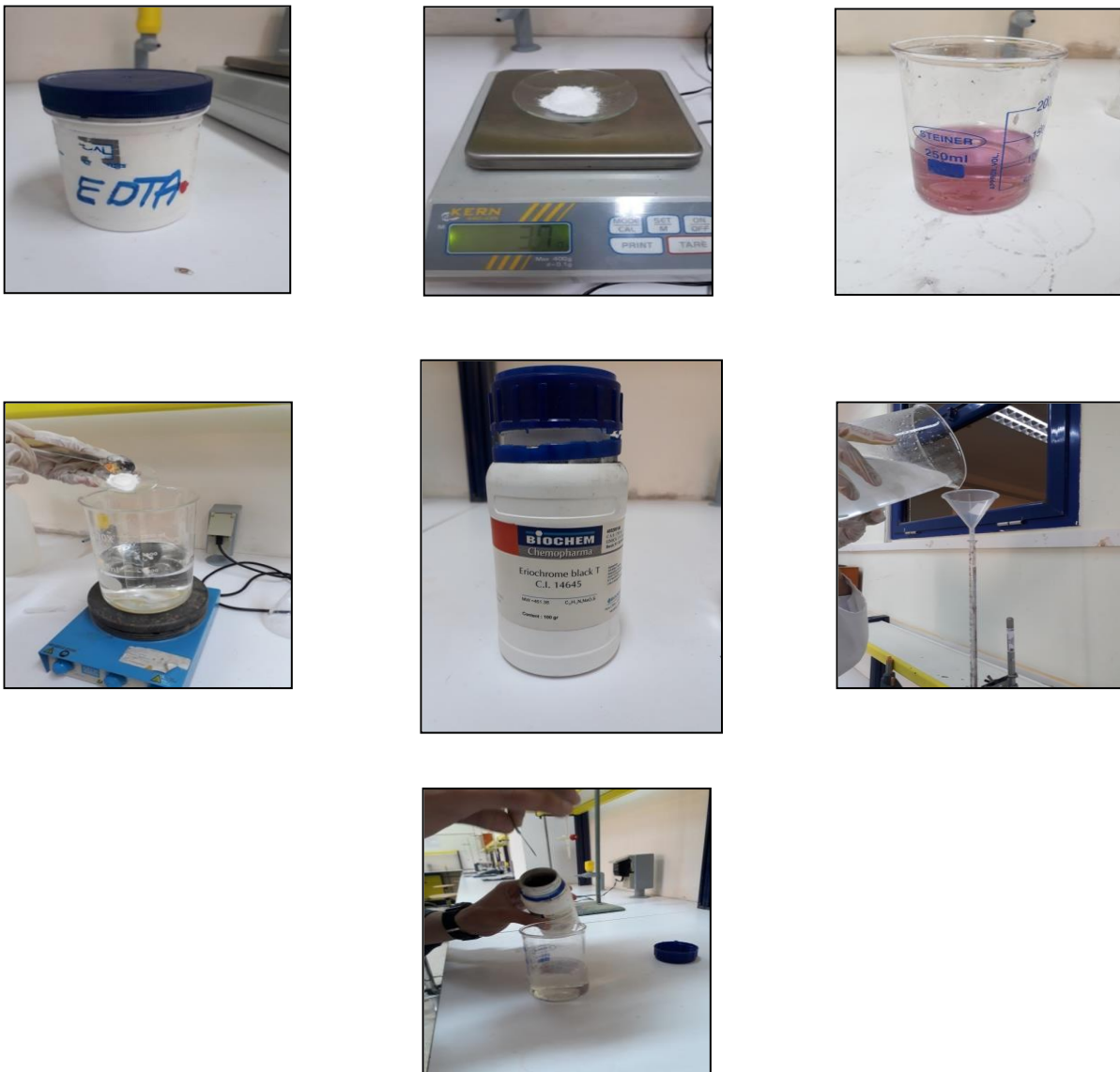
Figure 25: Les étapes de dosage ( \text{Ca}^{2+} + \text{Mg}^{2+} )
