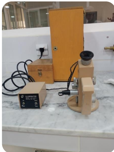
Figure 52 : Processus de mesure de degré Brix et d'indice de réfraction ( Original,2023 ).
