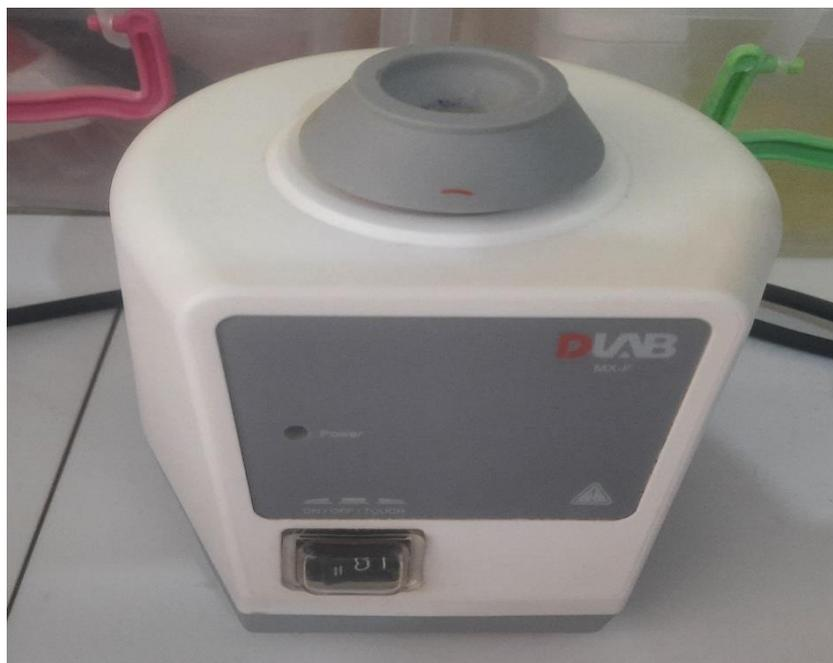
Figure26 : agitateur de type vortex.
