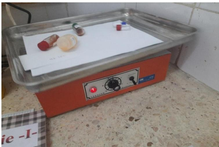
Figure21 : Agitateur qui assure l'agitation d'une solution et de réactif.
