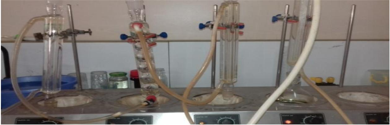
**Photo 3 :** Montage d'extraction sous reflux.
