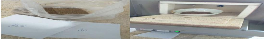
Figure15: détermination la teneur en MO. (LTPO,2023)
