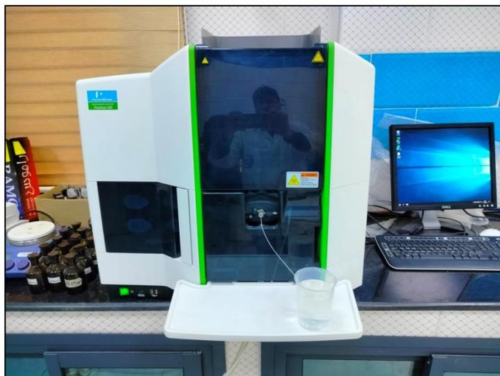
**Fig. 22- Spectromètre d'adsorption atomique « Integrate Coupled Plasma (ICP) »**
