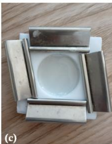
Figure II.5 : Les outils utilisés dans la synthèse des composites : (a) bain ultrason, (b) microbalance et (c) moule en téflon
